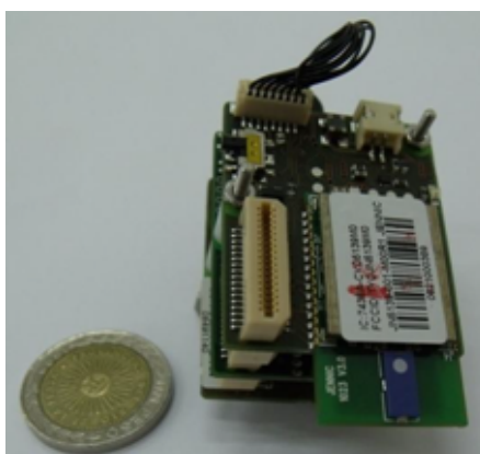
Figura 3. Nodo WSN implementado en el proyecto
