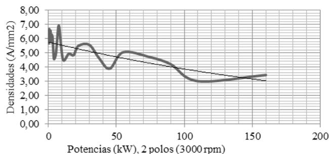
Fig. 2. Densidad de corriente  $\sigma$  (A/mm<sup>2</sup>) promediada en función de la potencia y velocidad, régimen continuo. (Fuente: datos de fabricación)
