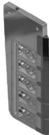
Fig. 3. Esquema de cuchilla desarrollada por la Universidad de California-Davis. (Fuente: Sudduth, K.A. (2008). Field comparison of two prototype soil strength profile sensors, pp 23.)
