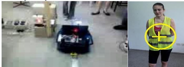
Figura 4. El operario se interpone en la trayectoria del robot fuera del alcance de los sensores de posición.
