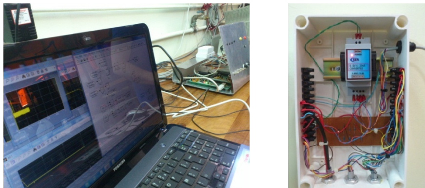
Fig 5. Notebook, placas ESD-32U y ESA-U y acondicionador de señales
